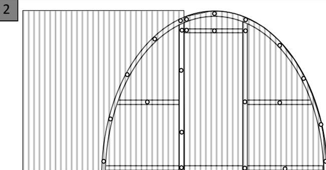
4.1.3. Второй частью поликарбоната (размером 2х2,10 м) покройте оставшуюся часть торца. Закрепите саморезами и обрежьте ровно по дуге. Оставшийся поликарбонат используйте для покрытия второго торца.
