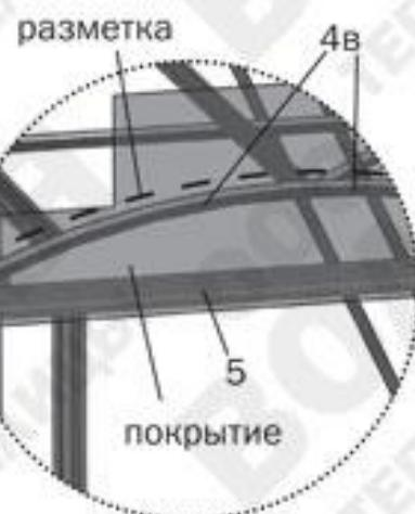
**3.** Установите боковины торца в соответствии с **рис.16**. Придерживая кусок покрытия, закрепите его винтами с шайбами по деталям **6к, 7,8** (**рис.18**). и по уголкам с помощью самонарезных винтов с шайбами. Отверстия для винтов выполняются сверлом диаметром 5 мм изнутри теплицы через готовые отверстия в деталях каркаса. Установите куски «кошкой панели», закрепляя их на уголок с помощью самонарезного винта с шайбой. Нахлест с боковинами срезать.
