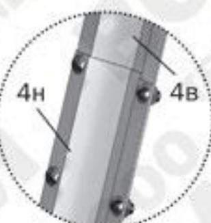
Закрепите дуги **4н** к дугам **4в** с одной стороны каркаса.
