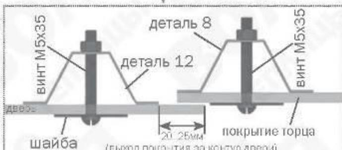
**7.** Установите собранные двери и форточки на торцы, устанавливая уплотнитель в соответствии с рис.22. При навеске форточек необходимо избегать ее дальнейшее возможное провисание. При затяжке винтов приподнять противоположный край форточки, чтобы выбрать зазоры винтов в отверстиях.
