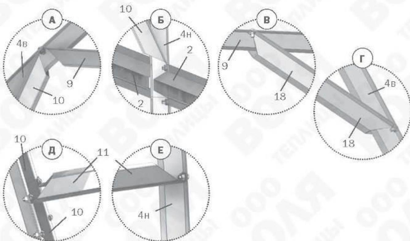
Установите внутри каркаса теплицы на каждой дуге боковые подкосы (детали **10**). Боковой подкос собирается из двух деталей **10**. Распорка бокового подкоса **11** устанавливается на стыке деталей **10** и крепится к дуге **4н**.
