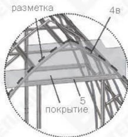
**3.** Установите боковины торца в соответствии с **рис.16**. Придерживая кусок покрытия, закрепите его винтами с шайбами по деталям **6к, 7, 8, 21** и по уголкам с помощью самонарезных винтов с шайбами. Отверстия для винтов выполняются сверлом диаметром 5 мм изнутри теплицы через готовые отверстия в деталях каркаса. Установите куски «конька», закрепляя их на уголки с помощью самонарезных винтов с шайбами. Нахлест с боковинами срезать.
