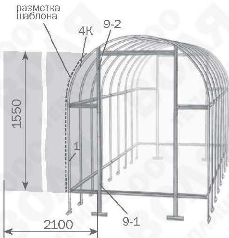
При разметке край листа строго совмещается по кромке деталей **9-1**, **9-2**. Вырежьте шаблон. Разметьте оставшуюся часть листа, используя вырезанный шаблон, в соответствии со схемой раскroя.
